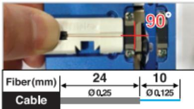
5. Chuẩn bị dao cắt chính xác (màu xanh) đặt sợi quang vào khuôn để chúng trên phần dao cắt và cắt sợi quang. Phần cáp đã được tuốt lớp áo đường kính 0.125mm dài 10mm. (Dao cắt phải tháo khurc ra.)
