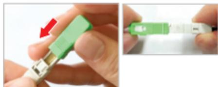
9. Lắp vỏ đầu nối vào phần thân đầu nối. Hoàn hoàn thành lắp ráp FAOC-VF. Khi lắp vỏ phải theo chiều đúng, nếu lắp sai sẽ không đẩy vỏ vào được.
